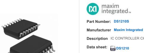
**Description** IC CONTROLLER CHIP NV 16-SOIC
